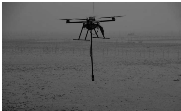
图6 磁力仪垂直安装于四旋翼无人机
