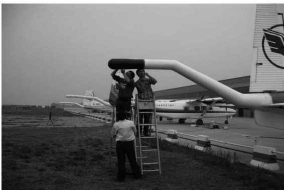
图3 磁力仪安装于飞机尾部磁探杆内
