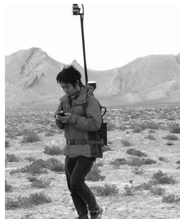
图 7 DGB-8 型地面氦光泵磁力仪及其使用方式
