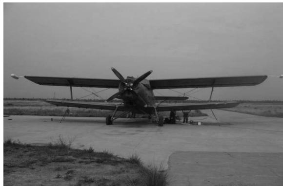
图5 磁力仪安装于飞机翼尖
